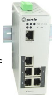
Der **IDS-305** ist ein **Managed Ethernet Switch mit 5 Ports**, der in **industriellen 10/100/1000-Base-T-Umgebungen betrieben werden kann**, eine erweiterte Leistung bietet und einen **deterministischen Netzwerkbetrieb in Echtzeit ermöglicht**.
